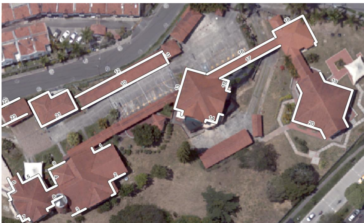
Imagen 22: Tramos disponibles para la instalación de canales para la recolección de agua lluvia Elaboración propia
